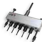
10003351 Tête de perçage en rangées 32 mm Pour le perçage en série dans des panneaux. Distance entre broches 4x32mm – y compris outils carbure 5 x Ø 5 mm et 2 tiges de blocage
